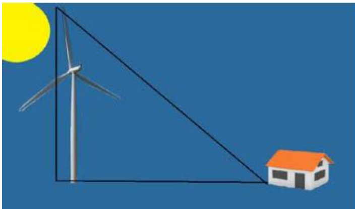
12. attēls. Ēnas mirgošanas veidošanās princips
