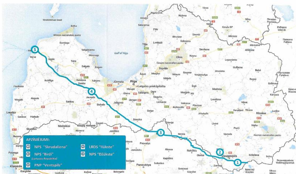
37.attēls. Maģistrālā cauruļvada shēma un Latvijas republikas un Lietuvas republikas teritorijā esošo LRDS, NPS un PNP atrašanās vietas [LatRosTrans rīcības plāns noplūžu gadījumos 2020]
